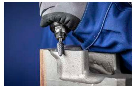
El recubrimiento HICOAT HC-NFE se utiliza principalmente para aleaciones de aluminio untuosas de viruta larga y metales no férricos, ya que impide la adherencia al material. Generalmente, todas las fresas de metal duro de PFERD pueden suministrarse también con recubrimientos HICOAT.
