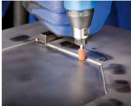
13 x 17 mm y 16 x 26 mm (tamaño de grano 60, 150, 280), diez de cada, 5 x 10 mm y 7 x 12 mm (tamaño de grano 60 o 80 y 150, 280) y portadediles POLICAP, uno de cada, de forma cilíndrica 5 x 10 mm, 7 x 12 mm, 10 x 15 mm (con mango  $\varnothing$  3 mm), 13 x 17 mm y 16 x 26 mm (con mango  $\varnothing$  6 mm).
