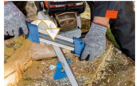
El afilador para cadenas de motosierra CHAIN SHARP CS-X aúna las funciones de una lima de limitador de profundidad y una lima de cadenas de motosierra en un aparato. Así puede afilarse el filo del diente al mismo tiempo que se ajusta el limitador de profundidad. Escanee el código QR para obtener más información sobre los afiladores de cadenas de motosierra de PFERD.
