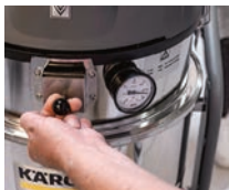
Limpieza de filtro Pull clean
