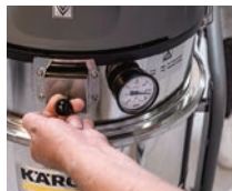
Limpieza de filtro Pull clean
