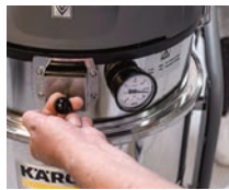
Limpieza de filtro Pull clean
