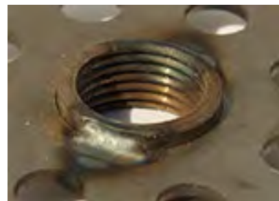
Soldadura sin deformación
