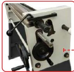
Volantes de ajuste de distancia entre rodillos
