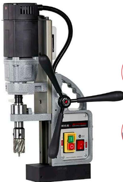
Superficie de contacto mínimo 5mm espesor
