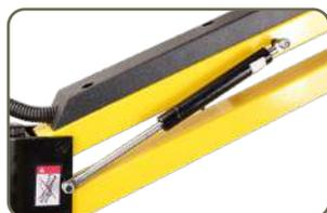
Doble brazo, doble amortiguador de aire. Soporte estable, retorno automático
