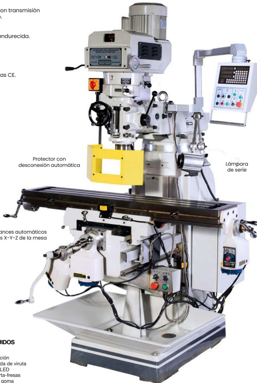
Visualizador X, Y y Z montado de serie
